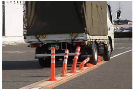
2tトラック 60km/hで繰り返し試験
